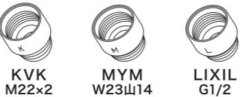
\*「シャワーホースのネジサイズがG1/2で合っている」「アダプターを接続している」状態で、シャワーホースとの接続部から水漏れがする場合は、シャワーホース側に元々着いているパッキンを付属のシャワーパッキンに着け替えて装着する事で改善する可能性がございます。
